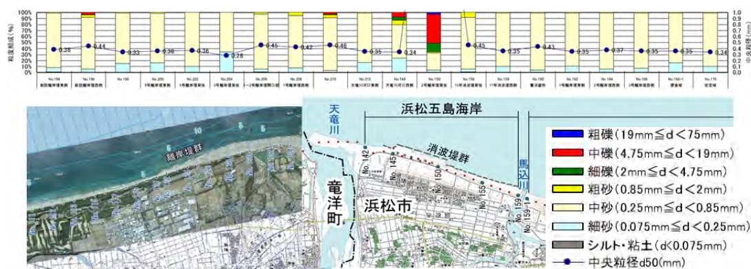
図 5-2(2) 領域毎の河床材料構成（粒径加積曲線）
