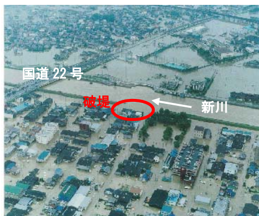
写真 2.1.3 新川の破堤地点の被災状況
