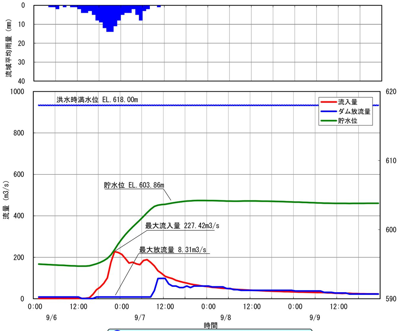
**41** 小渋ダム洪水調節図 平成19年9月6日洪水
