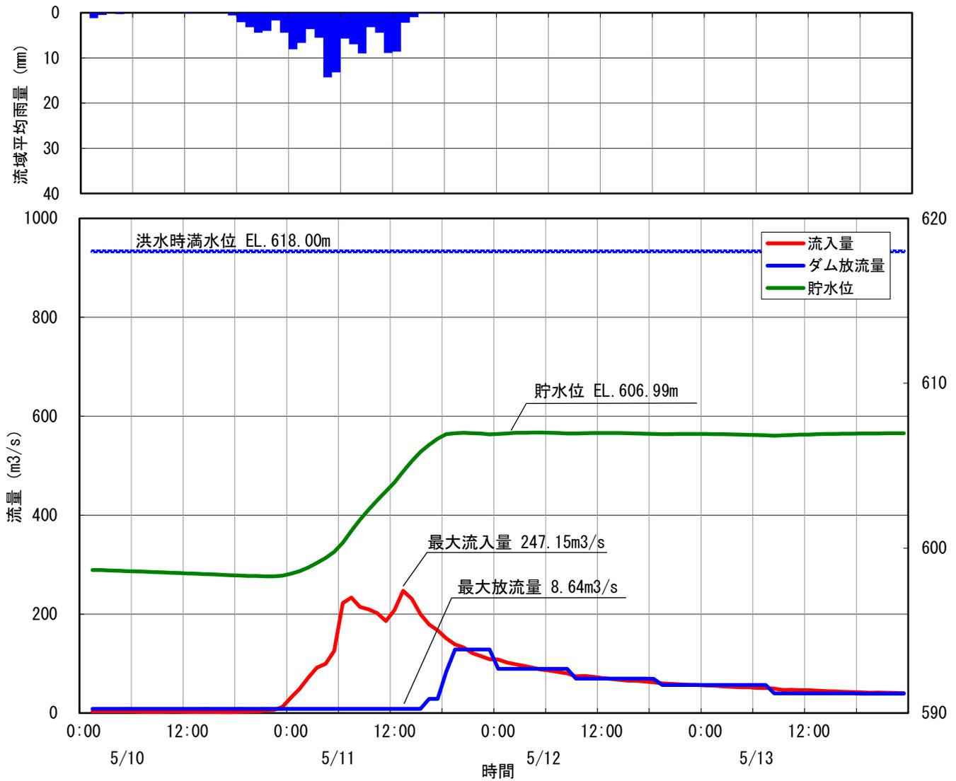
47 小渋ダム洪水調節図 平成28年5月11日洪水
