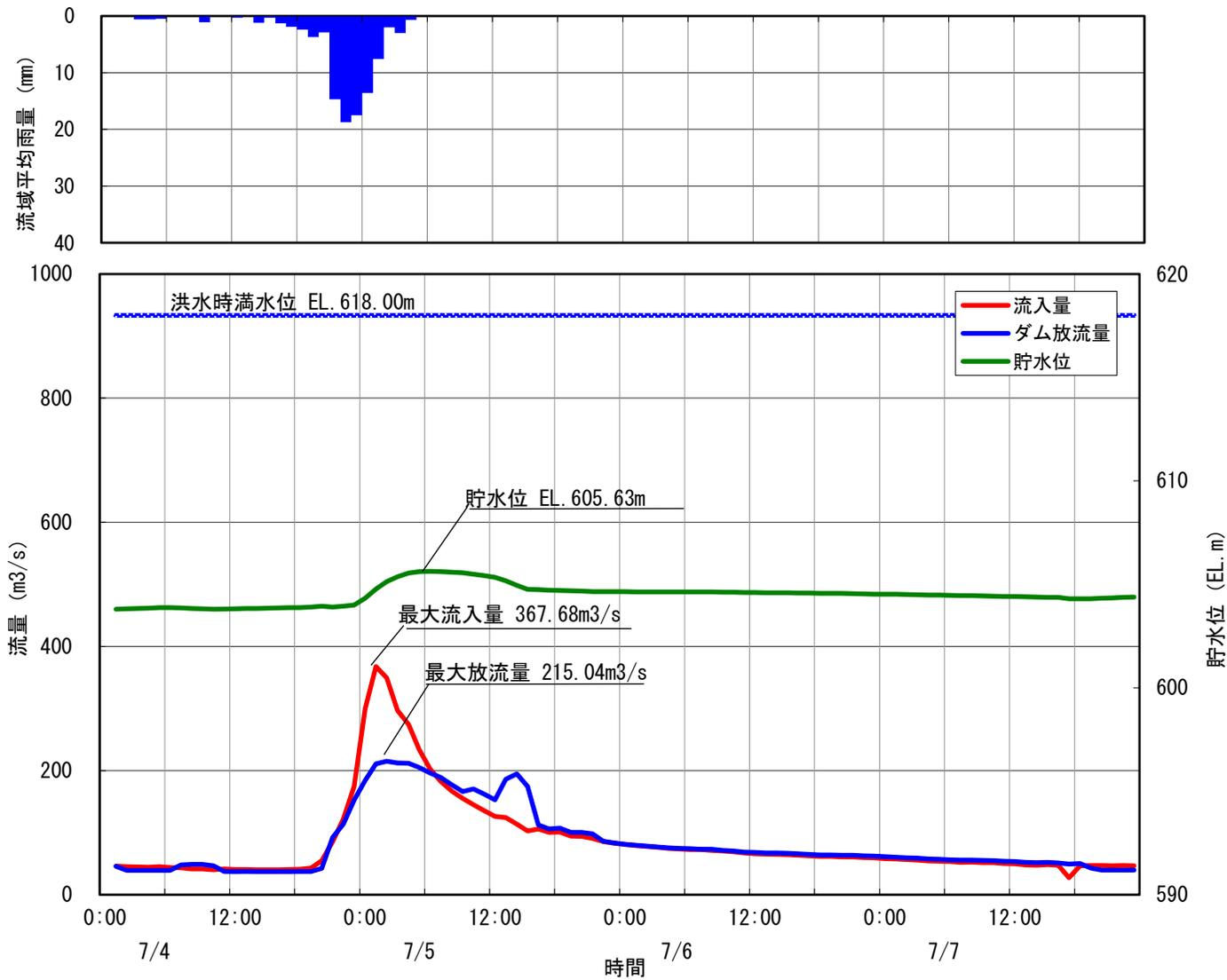
50 小渋ダム洪水調節図 平成30年9月30日台風24
