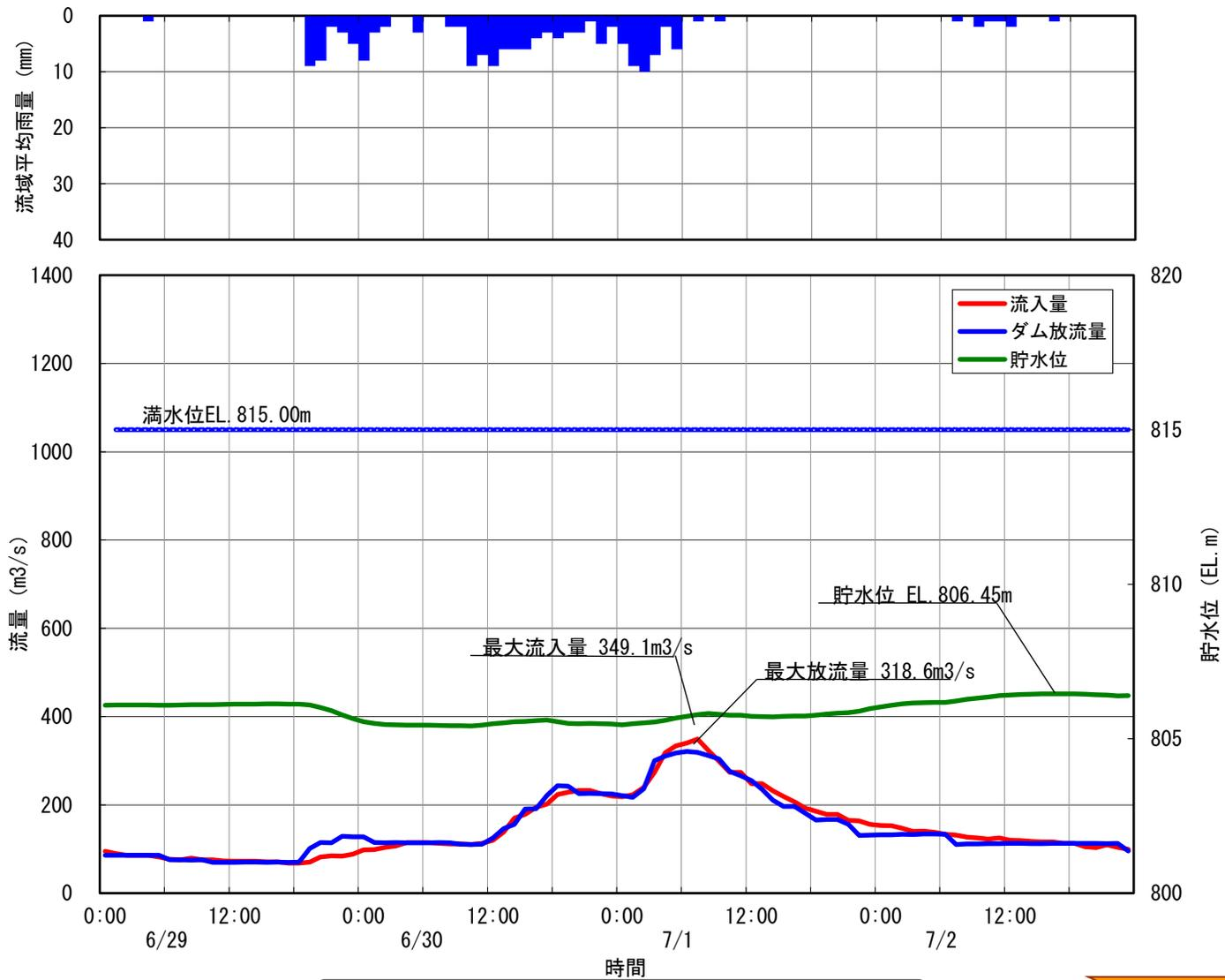
16 美和ダム洪水調節図 昭和60年7月1日洪水
